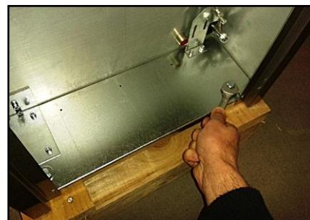
**-LOCALIZAÇÃO DOS PARAFUSOS 1 E 2 -DESAPARAFUSAR COM UMA CHAVE DE CABEÇA PLANA Nº 13**
