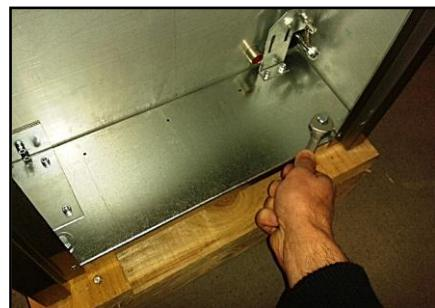
**UNTERBRINGUNG DER SCHRAUBEN 1 UND 2 MIT EINEM FLACHSCHLÜSSEL DER GRÖSSE 13 HERAUSCHRAUBEN**
