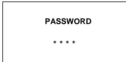
Para acceder al menú de usuario se deberá introducir el código 1-3-5-7. Mediante las teclas INC ( $\wedge$ ) y DEC ( $\vee$ ) se podrá modificar los dígitos y mediante la tecla SELECT, se podrá avanzar de un dígito a otro. Una vez introducidos los cuatro dígitos, pulsar la tecla SELECT para entrar en el menú de usuario.
