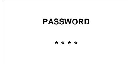
Para acceder al menú de usuario se deberá introducir el código 1-3-5-7. Mediante las teclas INC ( $\wedge$ ) y DEC ( $\vee$ ) se podrá modificar los dígitos y mediante la tecla SELECT, se podrá avanzar de un digito a otro. Una vez introducidos los cuatro dígitos, pulsar la tecla SELECT para entrar en el menú de usuario
