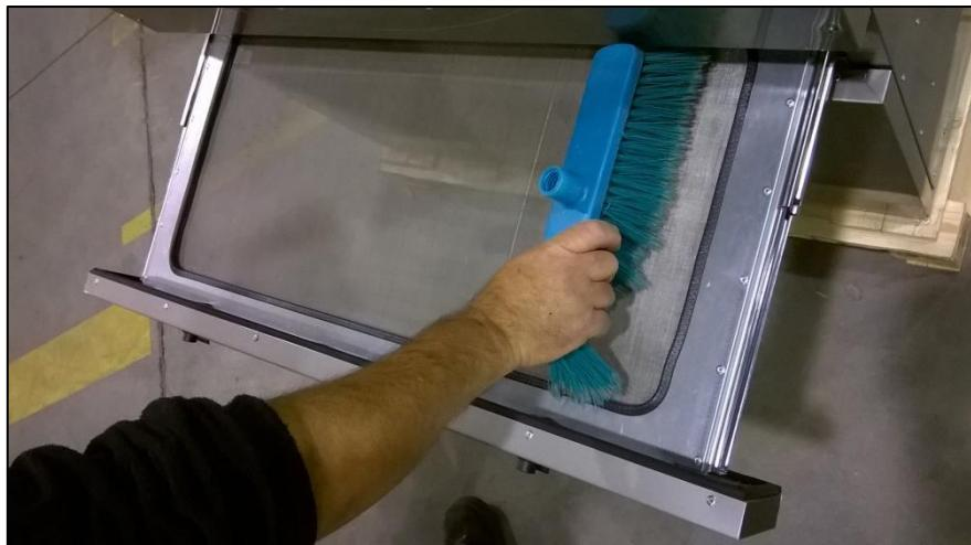
Рекомендуется чистить фильтр каждые 4 или 5 часов функционирования машины. См. раздел 9 Обслуживание.
