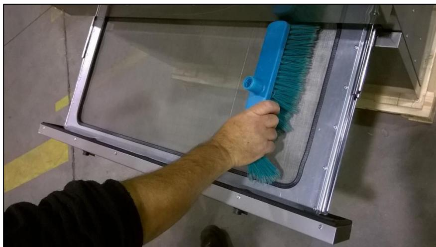
Werkseitig wird empfohlen, den Filter ungefähr alle vier bis fünf Betriebsstunden zu reinigen. Siehe Kapitel 9 Wartung.
