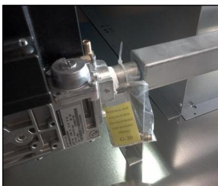
1- Установить форсунку сбоку от топочной камеры. Отвинтить форсунку при помощи гаечного рожкового ключа (на 13).
