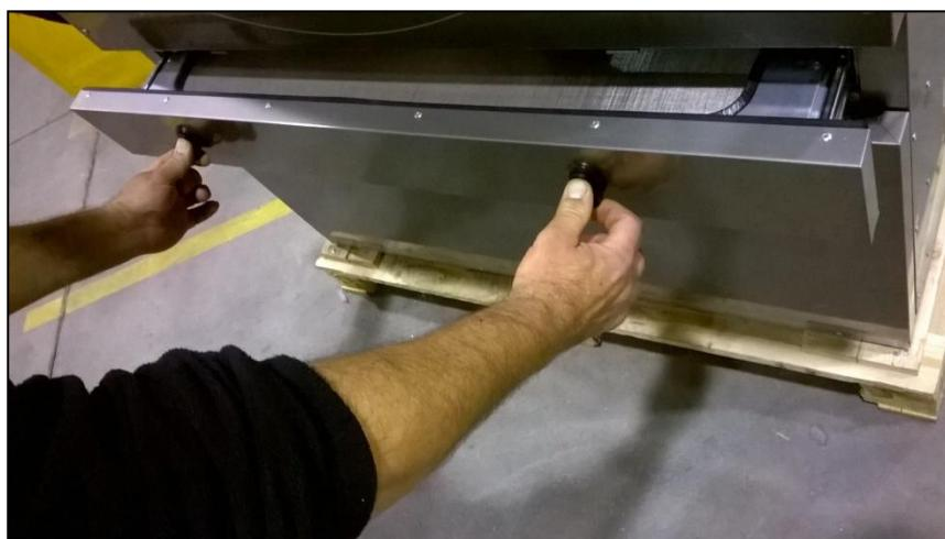
Para conseguir una mayor durabilidad, el filtro está construido con malla de acero inoxidable. Se recomienda limpiar el filtro con un cepillo que no tenga cerdas metálicas o de otro material demasiado duro. Si se limpia directamente con la mano, **precaución**, deben utilizarse guantes de protección.
