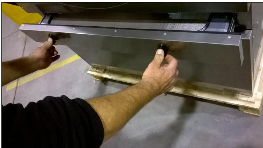
Pour une durabilité accrue, le filtre est constitué d'un treillis en acier inoxydable. Il est recommandé de nettoyer le filtre avec une brosse à poils doux. Ne pas utiliser des brosses à poils raides ou métalliques trop dures. Si le nettoyage se fait directement à la main, il est conseillé d'utiliser des gants de protection.
