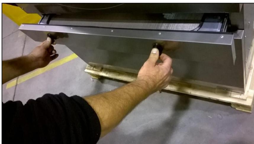
Per garantire una maggiore durabilità, il filtro è stato costruito con una rete di acciaio inossidabile. Si raccomanda di pulire il filtro con uno spazzolino privo di setole metalliche o di altri materiali troppo rigidi. Si pulisce direttamente con la mano, per prudenza si raccomanda di utilizzare guanti di protezione.
