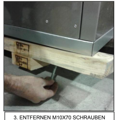
3. ENTFERNEN M10X70 SCHRAUBEN
