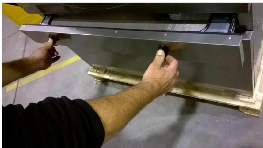
Para atingir uma maior durabilidade, o filtro é fabricado numa rede de aço inoxidável. Recomenda-se limpar o filtro com uma escova que não tenha cerdas metálicas ou de outro material demasiado duro. Limpa-se diretamente com a mão, pelo que se devem utilizar luvas protetoras por precaução.
